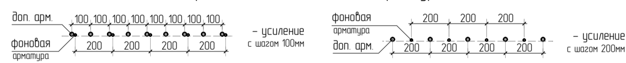
Схема раскладки стержней фоновой и дополнительной арматуры
